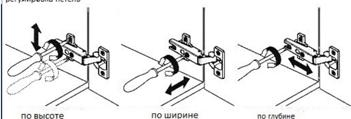
Регулировка петель:
