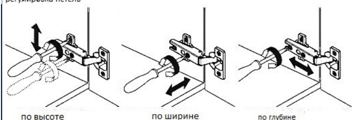
Регулировка петель:
