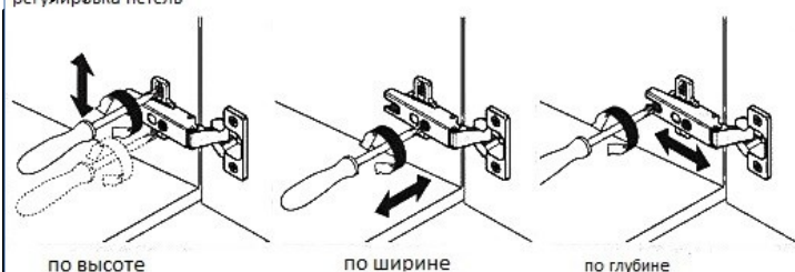
Регулировка петель:
