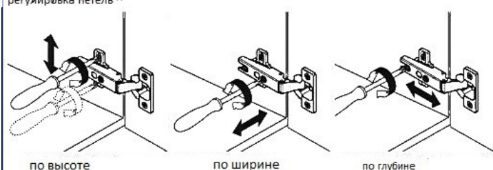
Регулировка петель:
